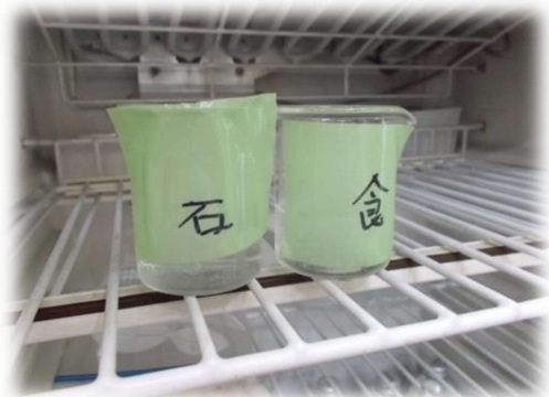
温度差によって溶けたものの析出の仕方の違いを確認
