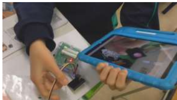
図 8 赤外線をカメラで確認している様子
